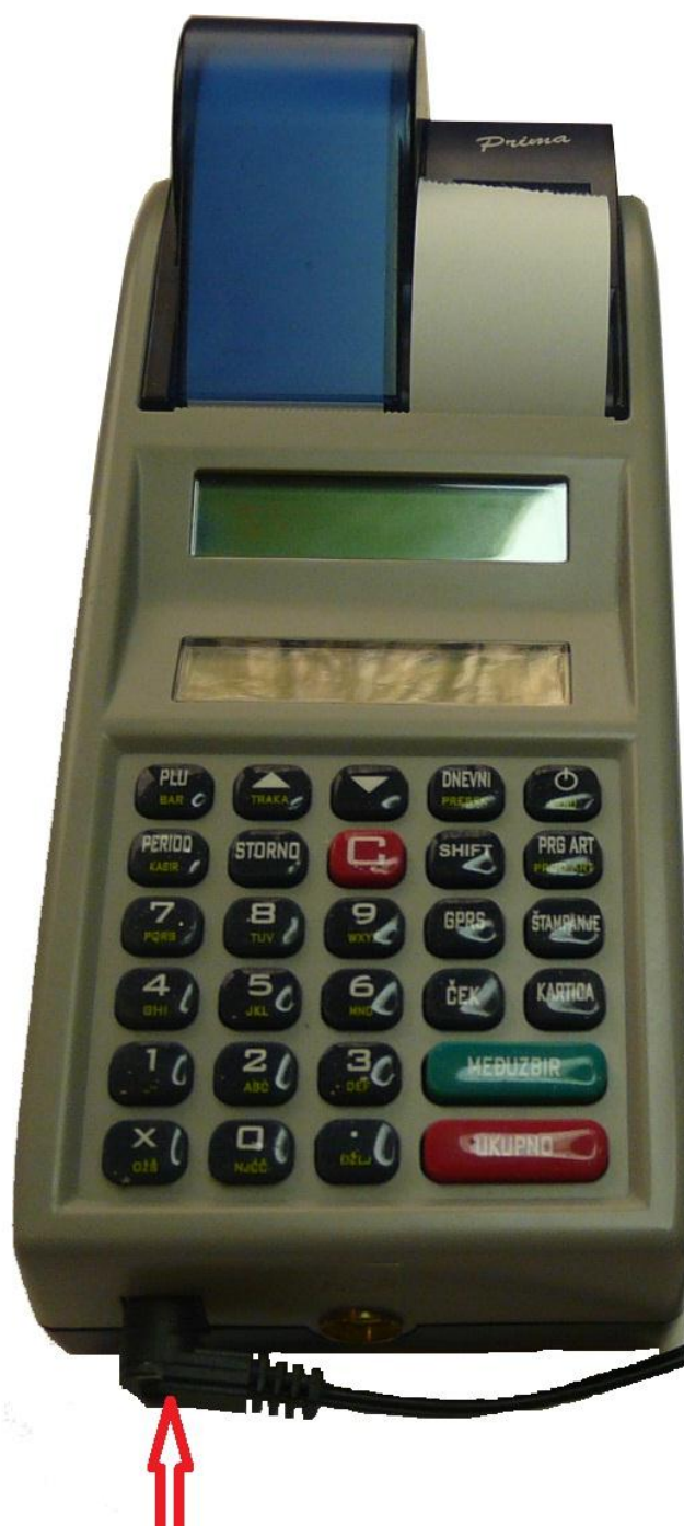
9VDC konektor za napajanje
