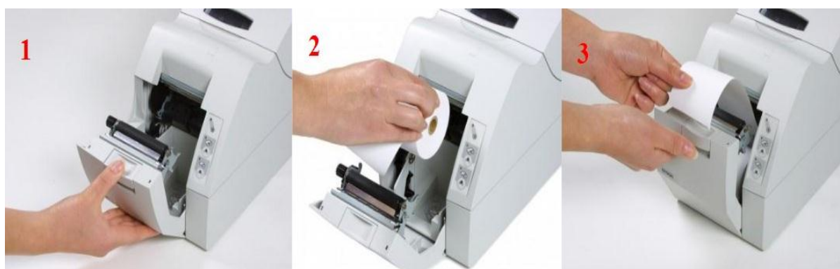
Slika 4.1 Zamena trake na EPSON TM-T260F fiskalnom štampaču (napred)
